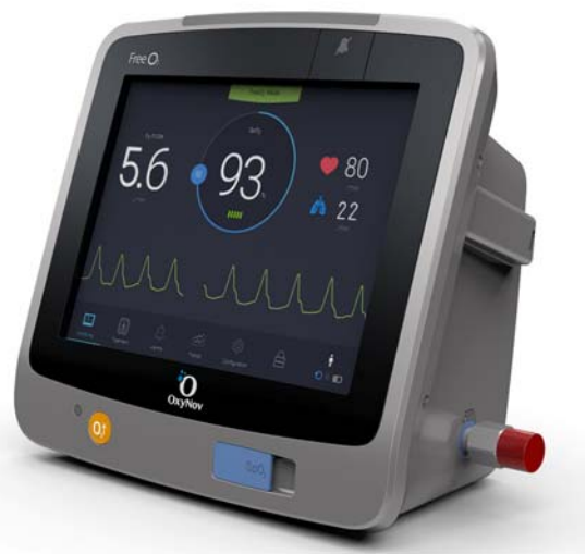
FreeO2 : titration et sevrage de l'oxygène automatique / surveillance des principaux paramètres cardiorespiratoires
